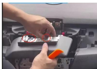
10. Entfernen Sie den Original-Bildschirm des Fahrzeugs und
